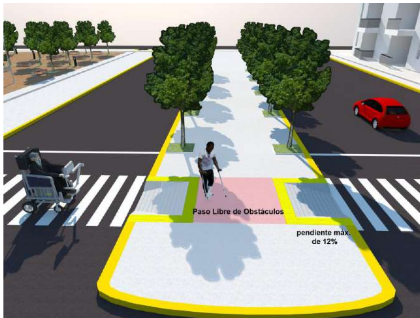
FIGURA 11. Detalle de calzadas y parterre central en donde el desnivel existente entre estas se salva mediante vados
