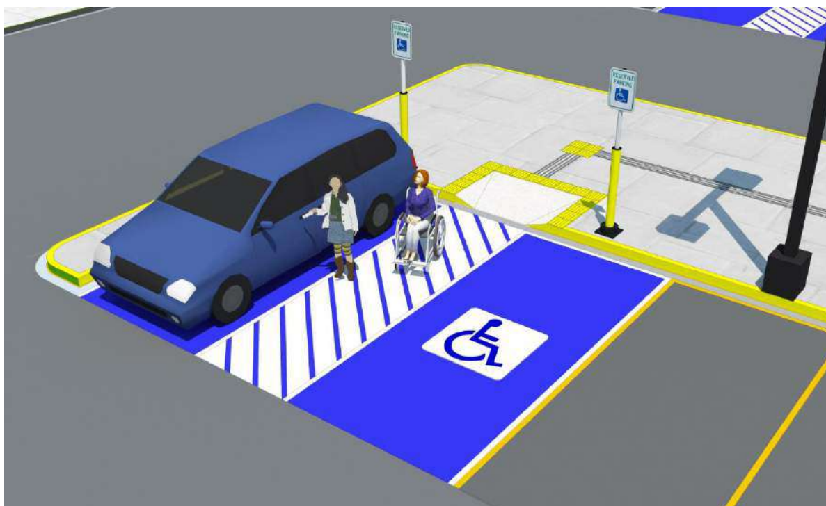
FIGURA 12. Ejemplo ilustrativo de bandas podotáctiles en estacionamientos
